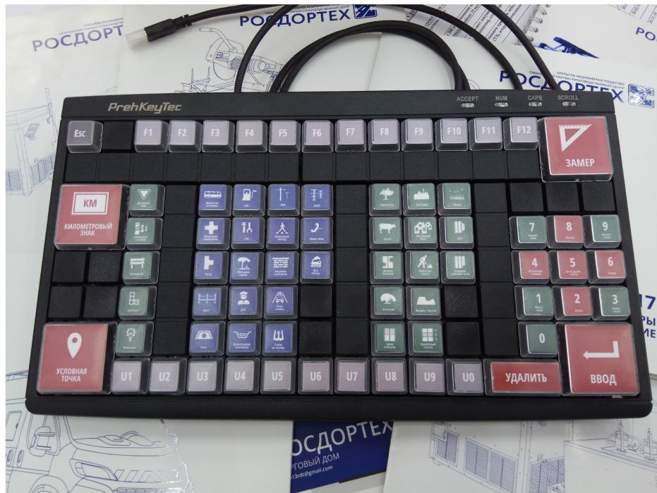
Рис.73. Клавиатура фиксации характерных точек дорожной инфраструктуры
